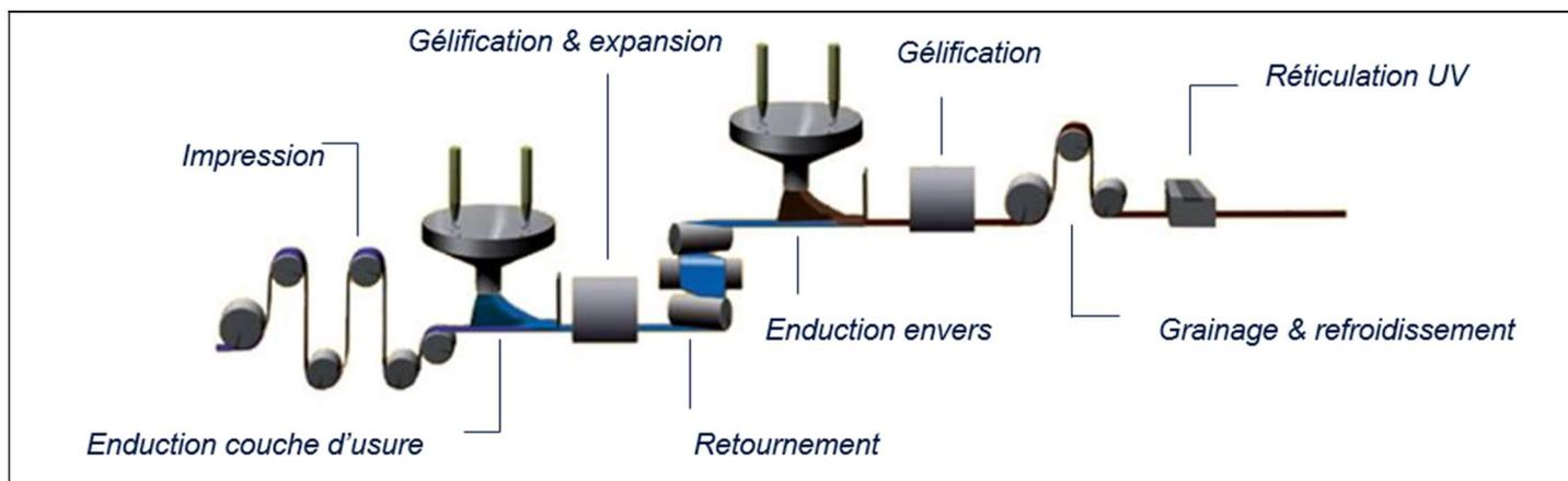
Figure 1 : Processus d'Enduction
